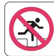
SP-140 PROHIBIDO SALTAR LAS ZANJAS
