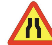
TP-17 ESTRECHAMIENTO DE CALZADA
